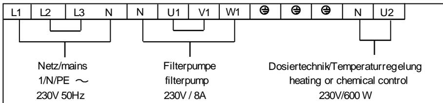
Damit der elektronische Motorschutz korrekt arbeitet, muss der Motorstrom über alle 3 Schaltkontakte der Filtersteuerung geführt werden (Klemmen L2 und L3 sowie U1 und V1 werden gebrückt). **Der Anschluss der Pumpe erfolgt an der Klemme W1.**
